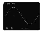
AC100V 50 Hz T1:90 deg (5ms) T2:0 T3: 0.5 ms T4:0 T5:0 V (T3):0 V
